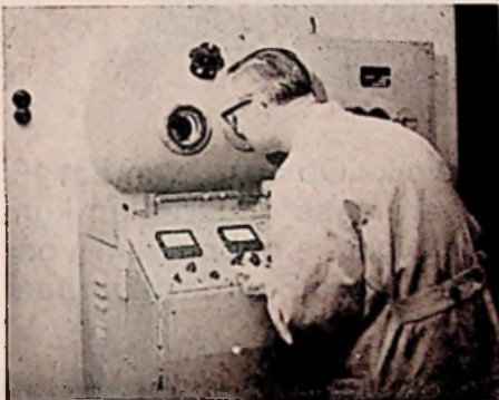
Het opdampen van Mylar met goud (in de vacuum-ketel) vereist vakmanschap en gevoel maar vooral inzicht!
